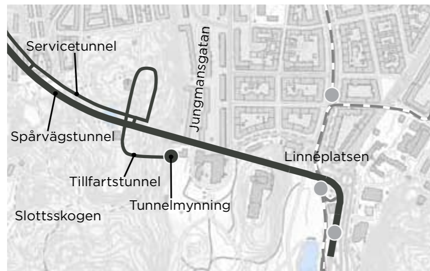
Figur 171. Tillfartstunnelns läge längs anläggningen (AFRY, 2025, bearbetad av COWI).
